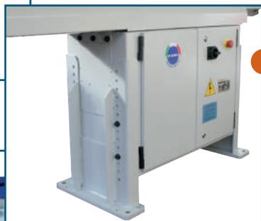
La struttura HD (Heavy Duty - Carichi Pesanti) del nuovo Boss garantisce che sia il caricatore ad assorbire la maggiore quantità di vibrazioni dalla barra in rotazione (anche del 60%) preservando il mandrino del tornio più a lungo nel tempo.
